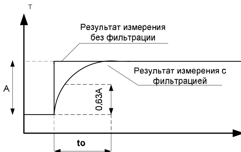
Рисунок 5 – Цифровая фильтрация результата измерения
